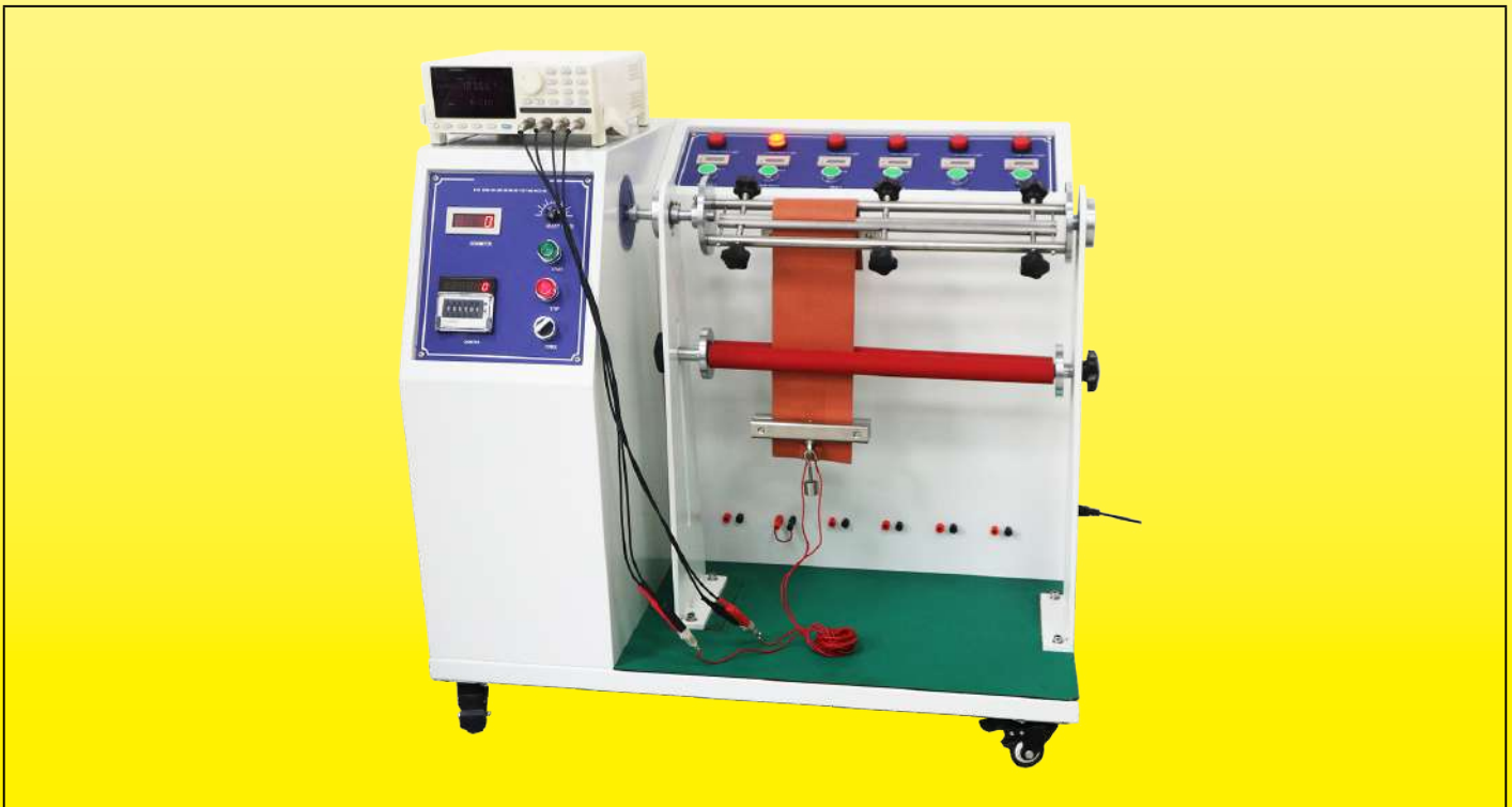
Flexible Silikonheizung während des Biegetests
