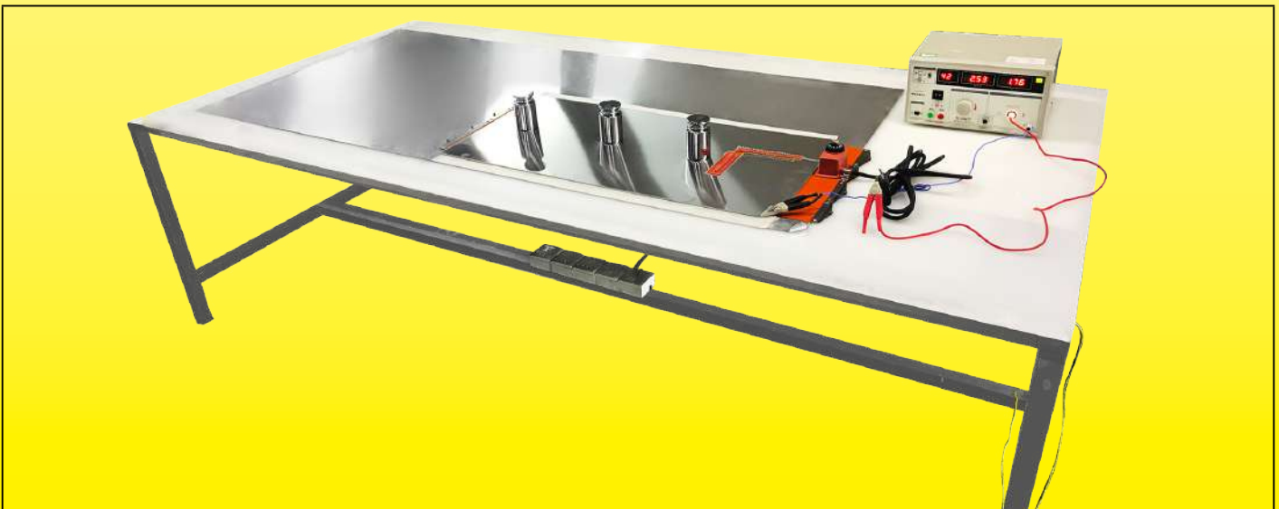
Messgeräte für den Gesamtleckstrom im kalten Zustand
