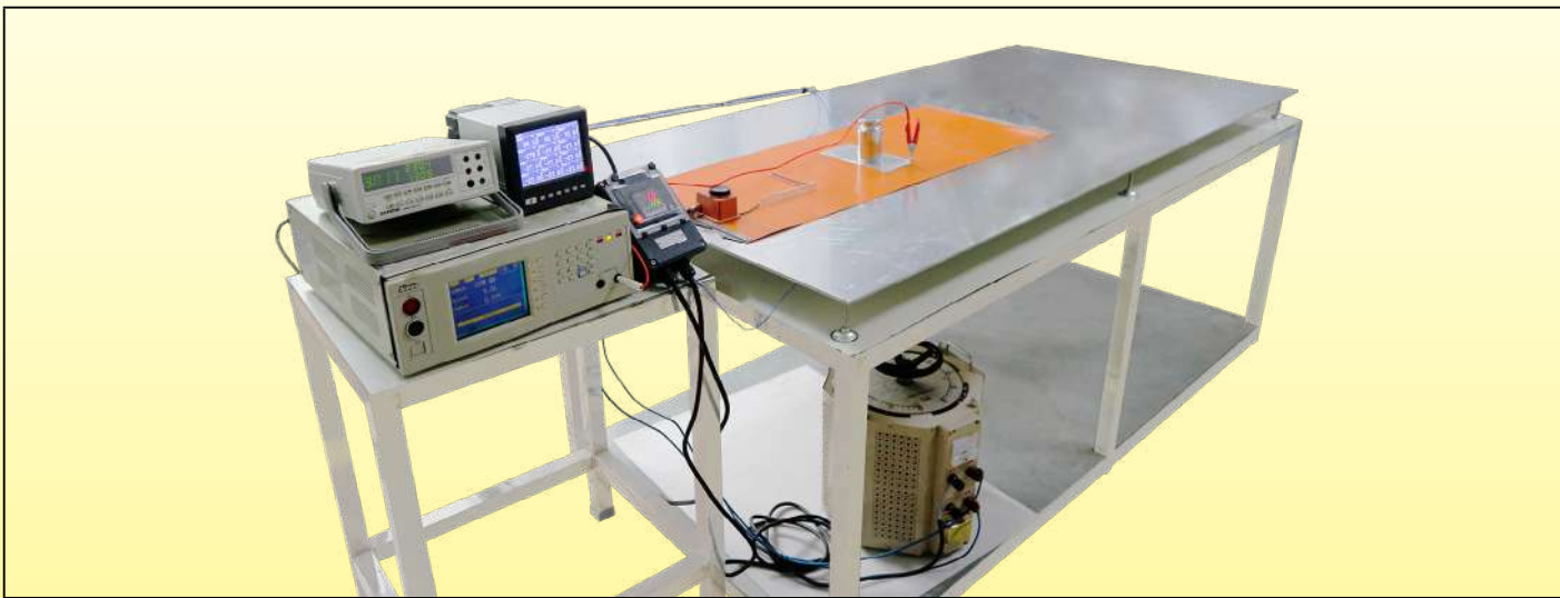
Messgeräte für den Gesamtleckstrom im heißen Zustand
